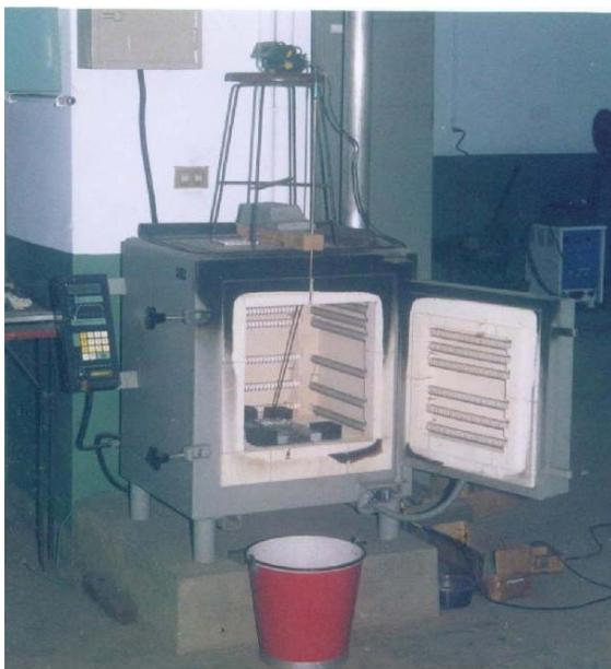
【圖 3】組裝後的熱處理實驗機台
